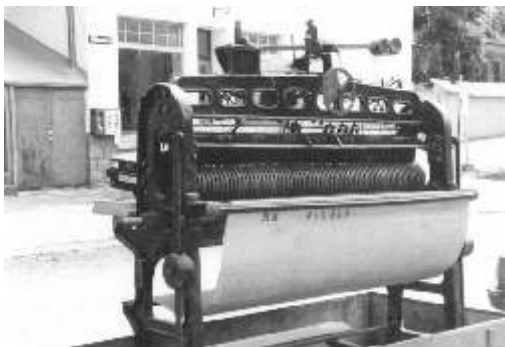
Maschine zum Abmessen des Leders für den Orthopädie-Gebrauch.
